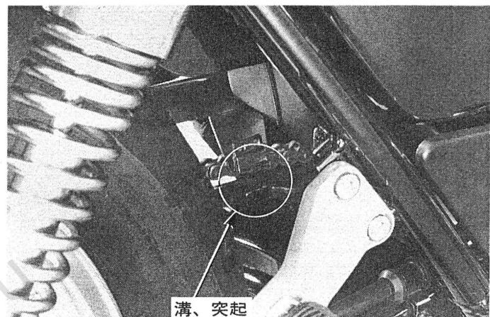
ドライブチェーンケースボルトを取り付け、締め付ける。
